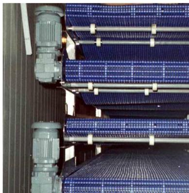
**Лифтовый транспортер** позволяет производить спуск и подъем продукции в вертикальной плоскости. Транспортер может выступать связующим звеном между технологическими линиями, расположенными на разных этажах производственных помещений.
