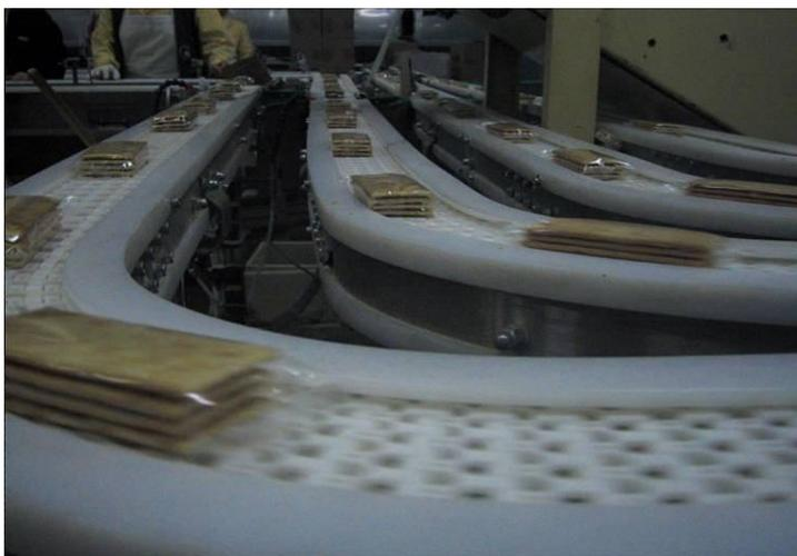
**Транспортеры с поворотным сегментом (модульная лента)** незаменимы на участках линий, требующих поворота потока, в условиях рационального использования производственных площадей. Применение модульной ленты делает конструкцию надежной, гибкой и ремонтпригодной.
