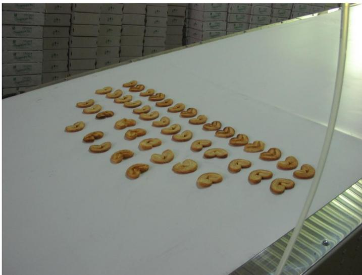
**Линейные транспортеры с ПВХ или полиуретановой лентой** применяются для транспортировки штучных и сыпучих грузов, различной тары. Модульная конструкция транспортеров обеспечивает гибкое построение конвейерных систем. Транспортеры так же выполняют наклонными, с различным углом наклона.
