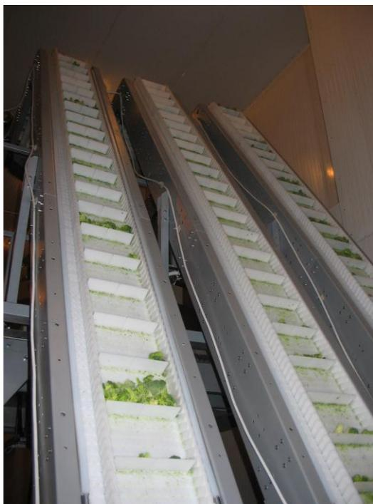
**Подающие транспортеры** предназначены для транспортировки продукции в дозатор фасовочно-упаковочной машины. Транспортеры могут быть выполненными различной высоты, с разнообразными типами лент. Возможно применение единичного или спаренного транспортера.
