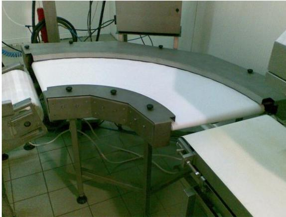
**Поворотные транспортеры с ПВХ и полиуретановой лентой** применяются на поворотных участках транспортных систем и комплексов различного назначения. Применение частотного преобразователя делает данный транспортер универсальным. Позволяет включать его в состав уже имеющихся конвейерных линий.
