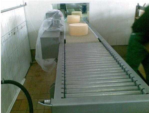
**Рольганги** применяются для перемещения малогабаритных и габаритных штучных грузов, в качестве окончания транспортных систем. Используются при создании накопителей готовой продукции.
