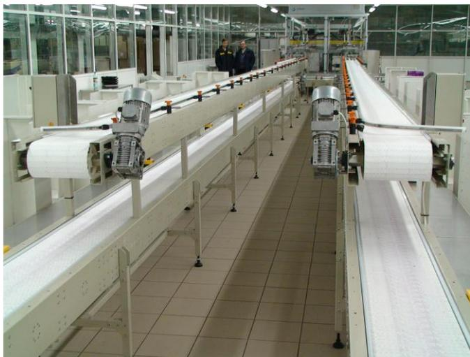
**Линейные транспортеры с модульной лентой** применяются для транспортировки штучных грузов и изделий различной массы и формы, картонной и другой тары. Возможно применение как отдельного транспортера, так и построение линий. В сочетании с поворотным сегментами позволяют составить сложные конвейерные системы.
